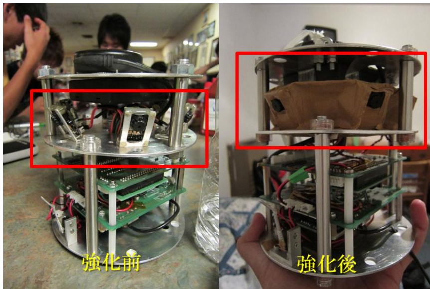
図4 カメラ低温対策強化前後の機体
