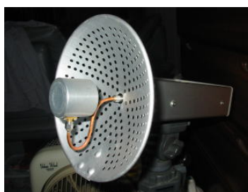
調理器具から5.8GHz帯パラボラアンテナ アマチュア無線家JA1UMWさんの製作例 http://park10.wakwak.com/~daisuke_elec/
