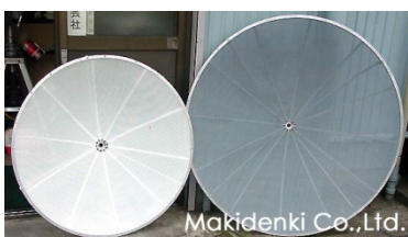
0.9m&1.2m パラボラアンテナ マキ電気 C-band(5.6GHz) 現在販売中止
