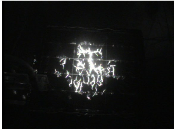
図1：宇宙用太陽電池表面での放電
