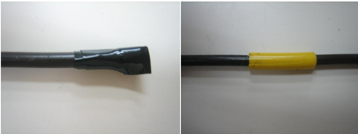
Fig. 2.2-3 エlementに巻き付けたビニールテープ
