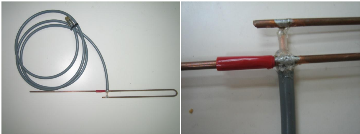
Fig. 2.2-5 輻射器用銅棒と同軸ケーブル
